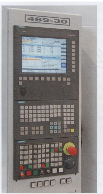
图2 带有 CNC (计算机数字控制机床) 控制装置的 Chiron FZ 12 W 型机床的操作控制区
