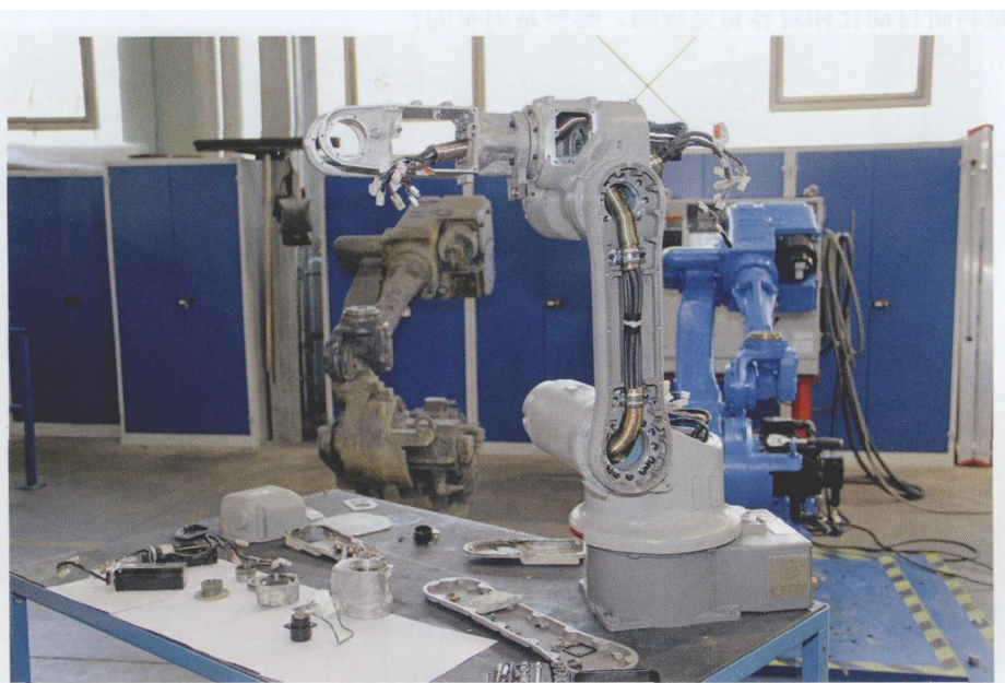
图 1 更换机器人内部电缆端分线是机器人大修翻新的标准作业
