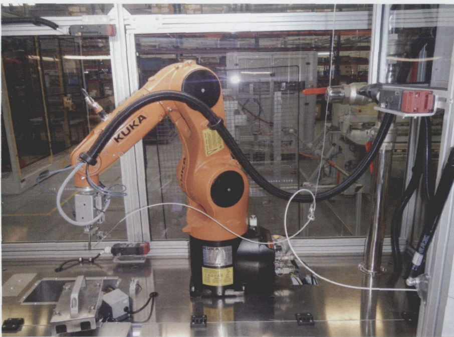
图 3 ALNEA-ZEUS 控制系统利用 KUKA KR AGILUS 机器人进行选择性锡焊使零失误成为可能
