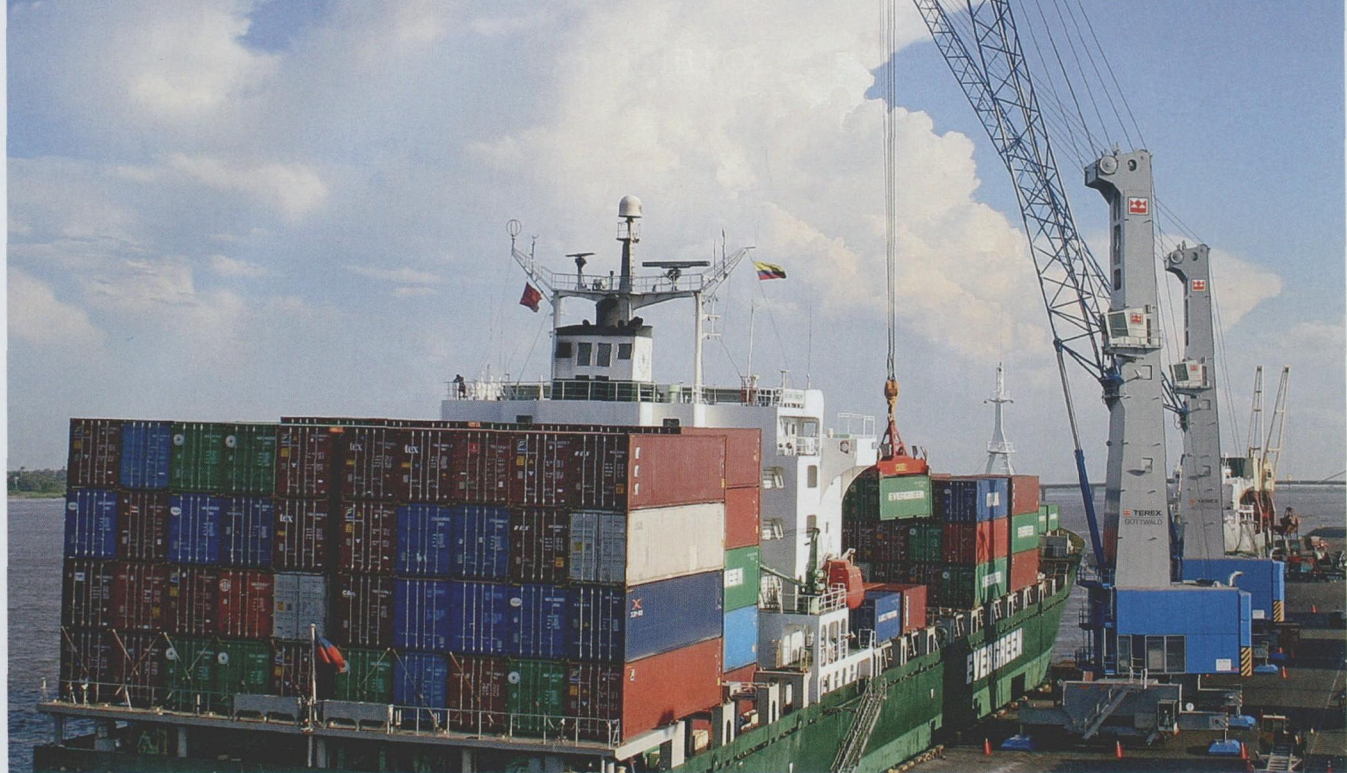
两部装有柴油电力驱动装置的 Terex Gottwald 6 型 港口机动起重机在南美洲的一个港口进行作业
