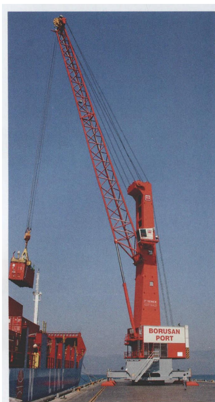
图 1 装有柴油电力驱动装置的 7 型港口机动起重机
