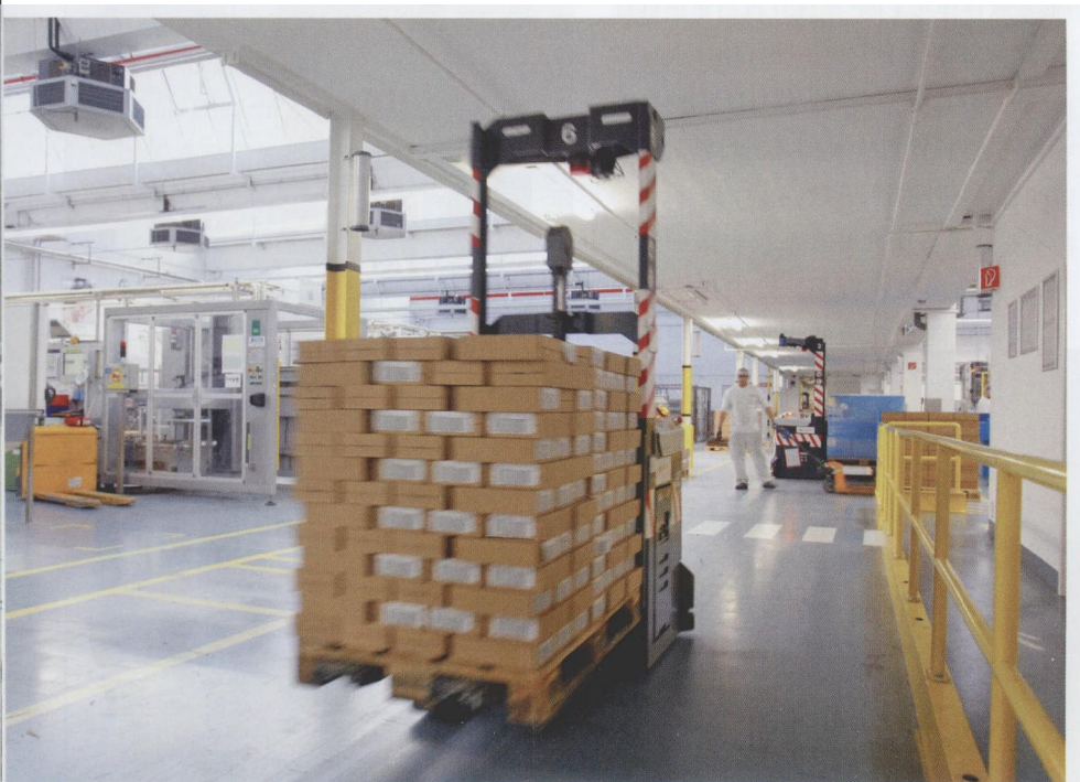
图 1 现在，欧莱雅公司在德国卡尔斯鲁厄的生产点投入使用的 Egemin 有限公司生产的导向控制运输车总共达 14 辆
