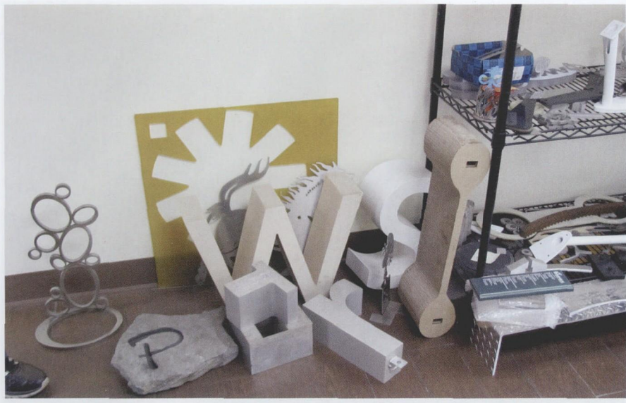
图4 水射流切割的各种形状、尺寸及材料参见 Hydroslice 接待处角落的一排零件样本
