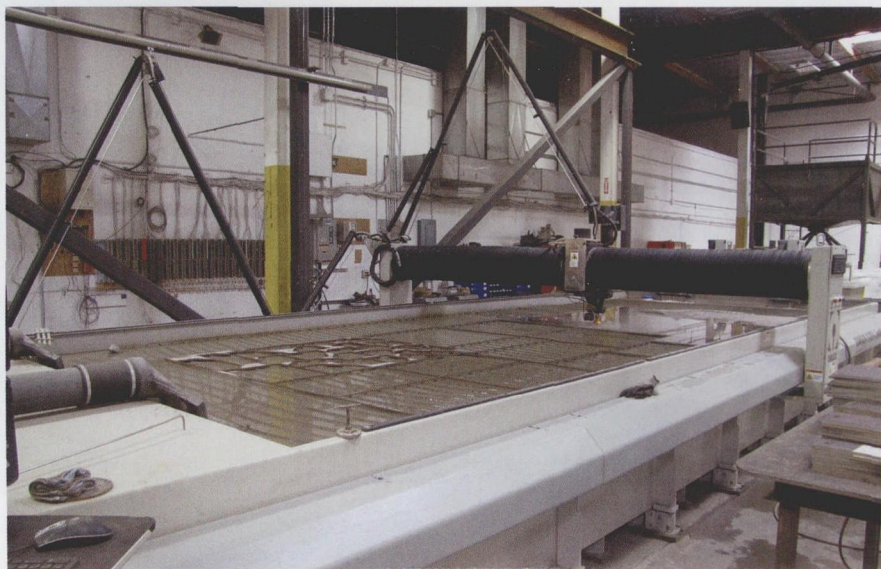
图3 Omax 120X 喷射加工中心为华盛顿肯特加工车间设施中四个大型机床水射流机械之一。由于性能是灵活性和高利用率的关键，该车间一般会投入大量机械（该模型具有 10×30 ft 的车床）
