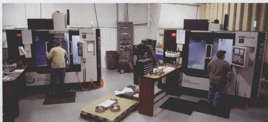
图1 SMTCL VMC1000B 立式加工中心拥有 47.2 in × 19.6 in 工作台,有助于提高工厂的灵活性,RDM公司在购买第一台立式加工中心后几个月就购买了第二台
