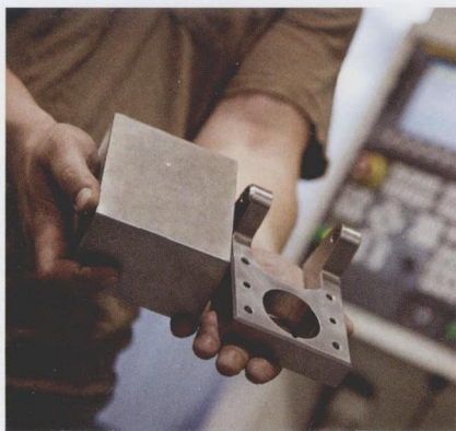
图2 投资购买新的立式加工中心之前,生产上图中青铜输送机停机铰链等零件对RDM公司的员工和设备提出了很高的要求
