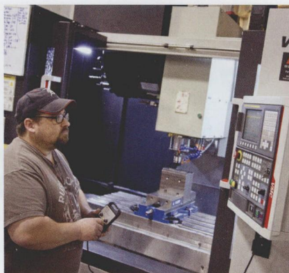
图3 RDM公司每月生产20~30个汽车底模,这些底模是通过切削H13模具钢而来的
