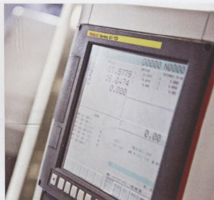
图4 VivaTurn4车床上配备的FANUC Oi-TD控制装置用途是提供强大的功能,目的是提高生产率
