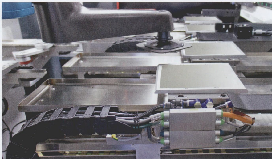
图 1 为了达到更高的产量，Manz 工程师们把激光光束分成两半并把激光引向两个独立控制的扫描仪上。由此，可以同时两个陶瓷膜进行加工
