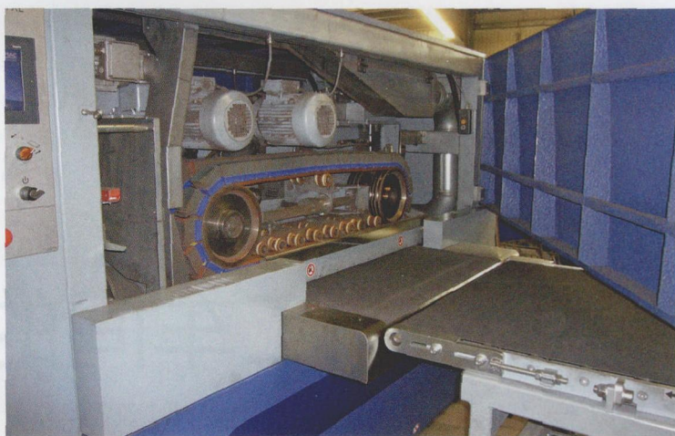
图4 两个反向运行的磨片装置可以对板材部件进行保护性加工，而不会产生切屑，油膜或塑料薄膜保护层也不会受到损伤
