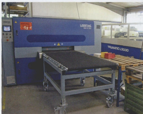
图2 Lissmac 磨刷设备每个月都会对所切割的 30 ~ 40 t、厚度在 10 ~ 20 mm 之间的钢板部件进行去毛刺、做倒角或进行表面处理
