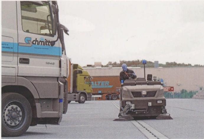
图 2 在室外物流作业场地上，Schmitt 物流有限公司采用装有柴油驱动装置的 KM 150/500 型工业扫地机，这样，既能够清除地面上细微的脏东西，又能够清除大的脏东西
