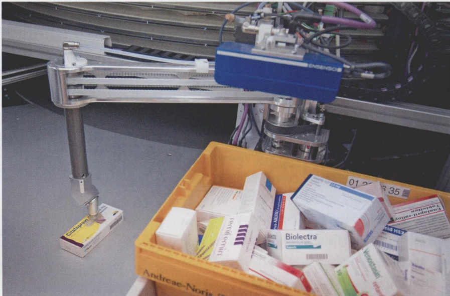
图 4 Magazino 公司研制的药品拣选自动化装置里的立体相机安置在中央位置，在相对靠近正在清空的药品批发箱的上方驶过
