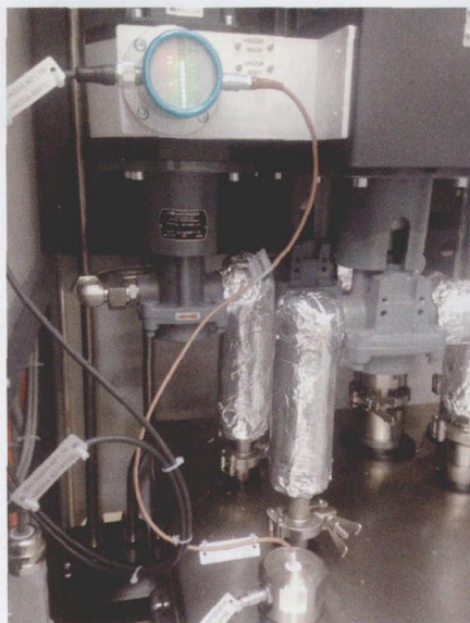
凯本隆 VA-214 液位传感器集成了双重监测功能, 在高温环境下, 同时实现精确的液位和温度监控, 完美地满足了客户的应用需求
