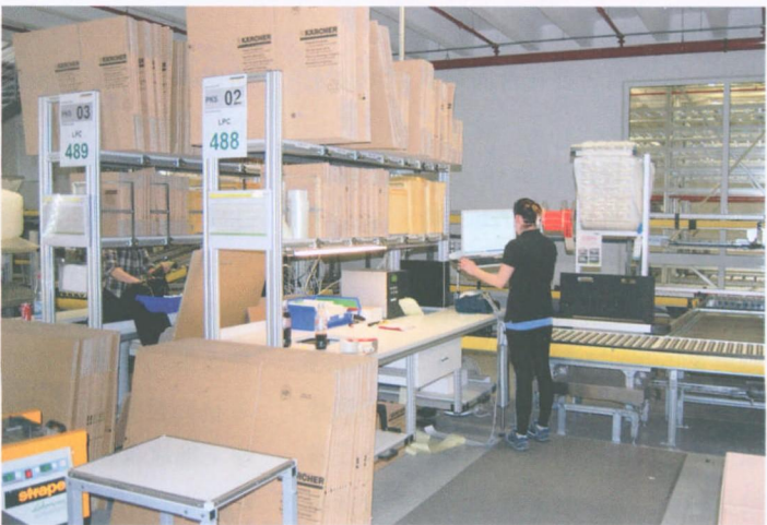
图 6 装有物品的容器在 24 个包装工位上按顺序出库
