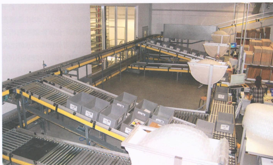
图3 托盘输送供料装置正在为发货包装工位供货
