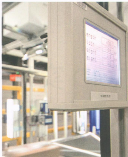
图2 显示器上通过视频显示出当前采集的通过传输装置的包裹的数据
