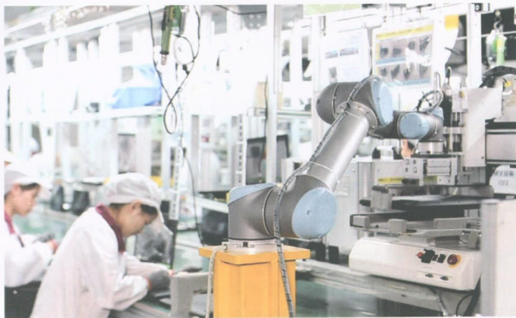
图 2 UR 机器人应用在纬创资通的笔记本电脑组装线上
