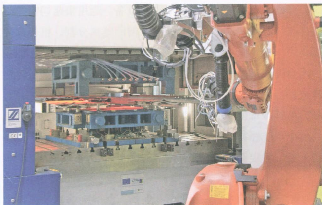
图 1 在新的程序工艺中投入了一种力学多伺服压力机
