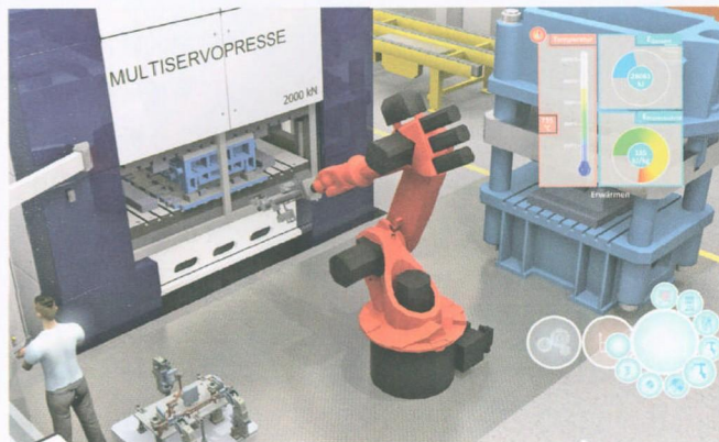
图 2 为了设计和验证研究，首先要搭建一个虚拟的工序环节 3D 模型，来反映接近实际情况的程序数据
