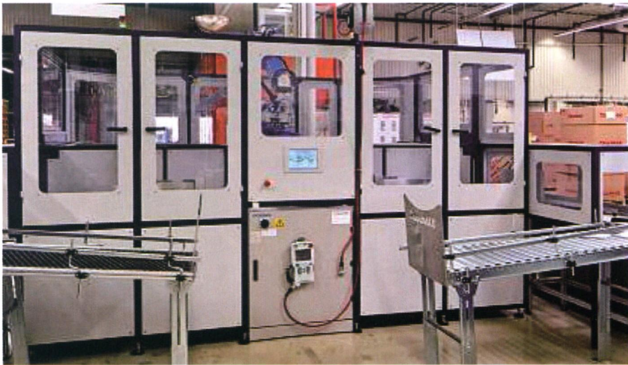
图 1 设备操作情况方面的观点：设备主要由一块触屏（中间）来控制。机器人控制的程序设备电缆（中，下方）由一个拉回系统控制。卷带实现了件数较少的特殊纸箱或者不规则大小的纸箱的提取
