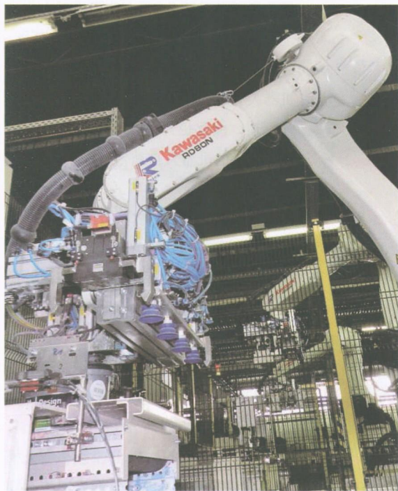
图 多爪机器人在处理垛板、内衬垫板和工件
