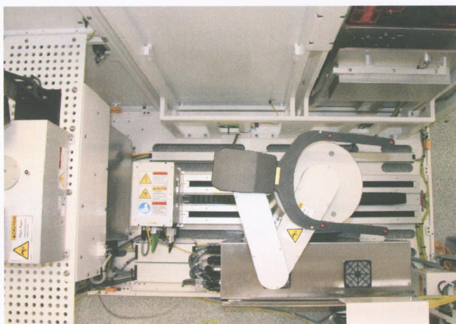
图 3 带线性轴和预对准器的晶片装卸器用于处理 300 mm 晶片
