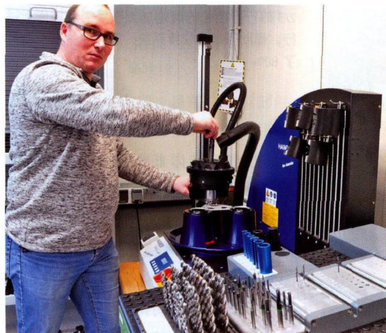
图2 NBF 公司的 Mark Harleman 先生在热套机旁工作，简单和快速刀具更换是热套机的强项
