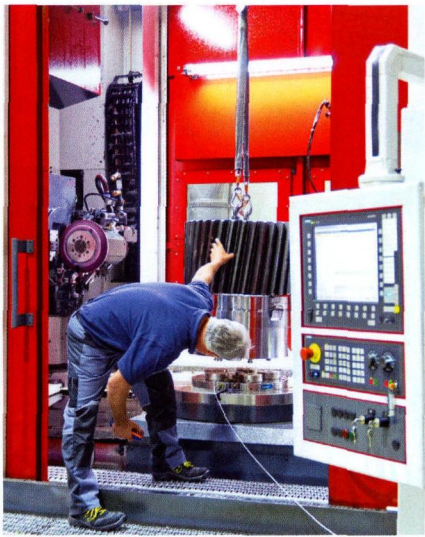
图 3 在将工件转换到第 2 台机床时, Preinfalk 公司获得平面平行度 < 0.002 mm, 而行星齿轮始终处于在工装夹紧的状态
