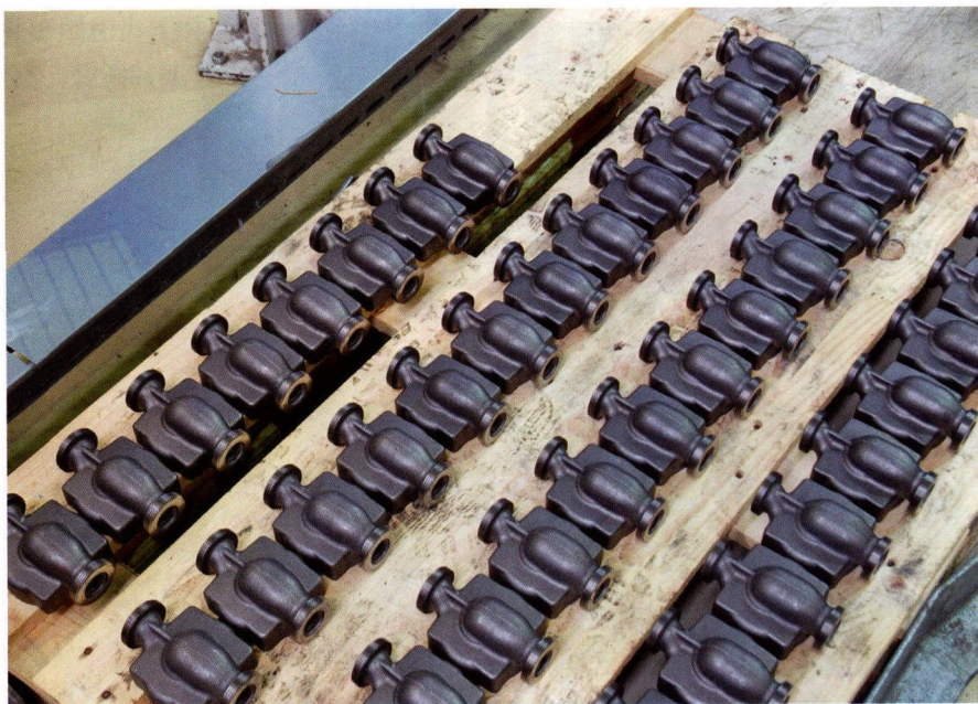
图 1 在加工批量为 150 ~ 8400 台的热循环泵壳体
