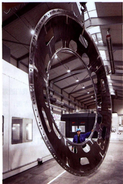
图 2 有了立式车床,Haco 专注于生产圆形的大型工件
