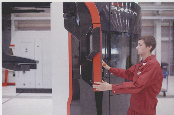
图3 Supfina 公司的 Planet V 由价格便宜的标准部件和个性化设计元素巧妙搭配而成
