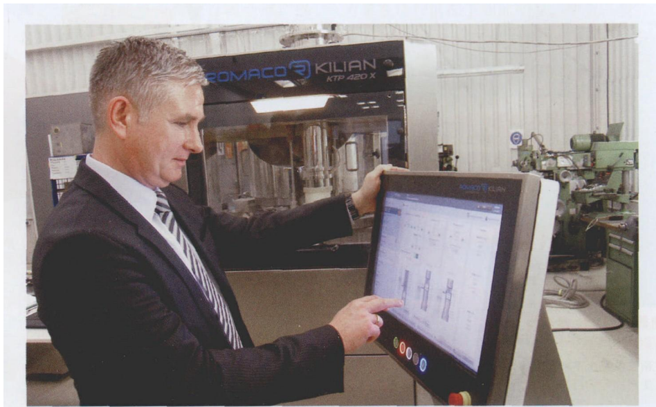
图 2 全新设计的 HMI 系统带手势控制功能，它基于采用双核 i7 处理器的 Automation PC 910 以及带 21.5" 显示屏的卫生级 Automation Panel
