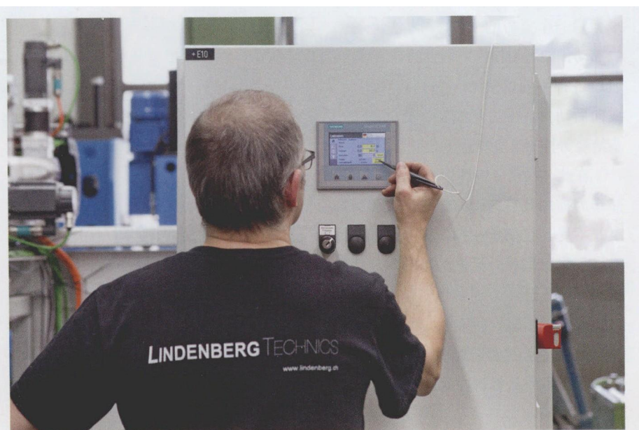
图1 所有信息均在一个 4-英寸 - 操作器上: 在一个专业媒体里, Simatic - HMI (中央控制计算机) 装置 - 主 - 操作屏将所有流程图像化
