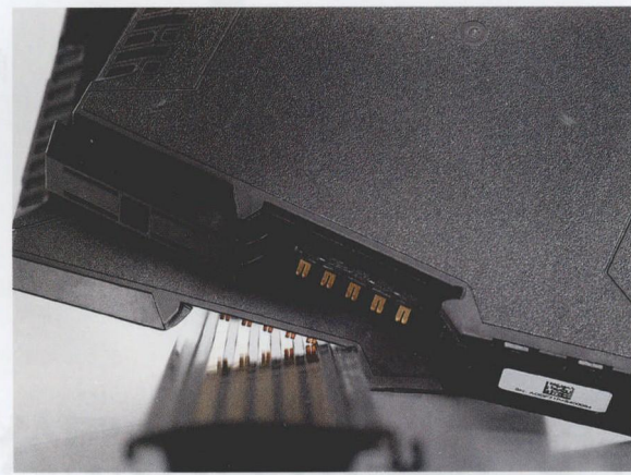
图2 据称，借助于测量站点的即插即生产（Plug and-produce）和快速 - 交换（Hot-Swapping）设计方案可加速安装 - 和保养维护作业，从而提高企业的经济效益
