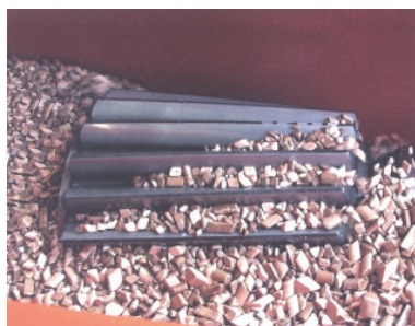
图2 表面滚磨光整中的齿轮轴
