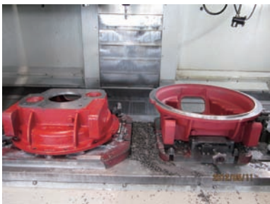
图2 15410系列离合器壳体原加工夹具
