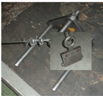
图3 气缸盖第一工位吊具
