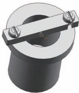
图2 填充叶轮零件外形辅具示意图
