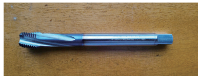
图2 高性能粉末冶金钴高速钢丝锥
