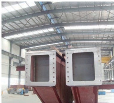
图8 加工后的主梁挂板及联接孔
