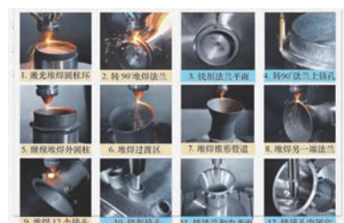
图4 涡轮增压壳体的12道混合加工工序
