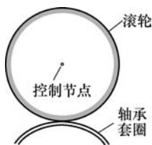
图2 滚轮与轴承外圈的静压接触模型
