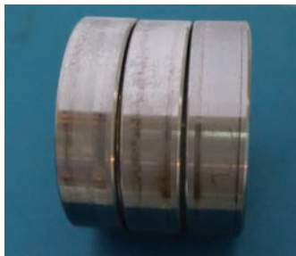
图5 61903抗疏轴承外圈外表面擦伤图示
