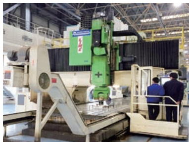
图1 为沈飞改造的双龙门五坐标铣床
