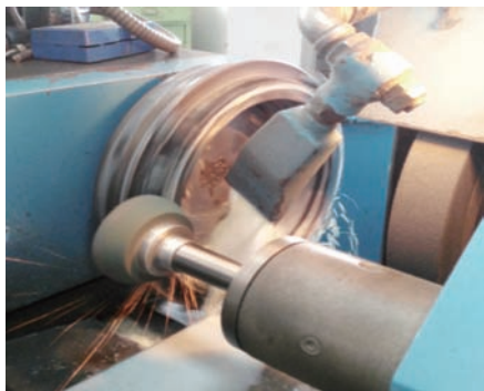
图7 端面及肩面磨削方法
