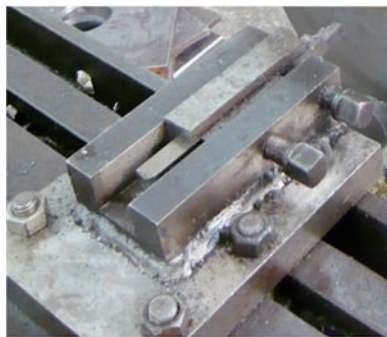
图4 刀具夹具效果图
