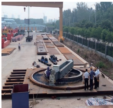
图3 正在进行加工作业的悬臂铣
