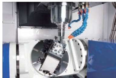
图15 定轴加工检验件
