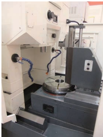
图1 带尾座的插齿机
