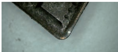
(d) 钻孔55 000个，心部切削刃磨损图
