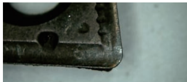
(c) 钻孔25 000个，心部切削刃磨损图
