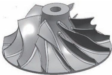
图1 带有分流叶片的叶轮
