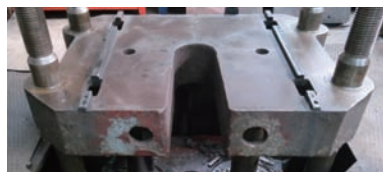
图4 改造后液压缸活塞杆升起状态
