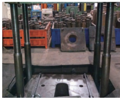
图5 改造后液压缸活塞杆落下状态
