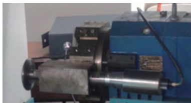
图5 试验用的轴向超声振动滚压系统
