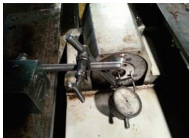
图4 检查滚珠丝杠轴向窜动
