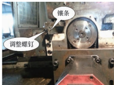
图5 X轴伺服电动机端安装图
