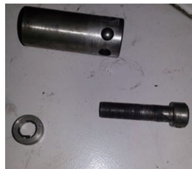
图8 主轴内刀具夹紧装置
