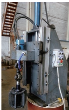
图2 珩磨加工示意图
