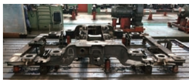
图2 构架的装夹方法
