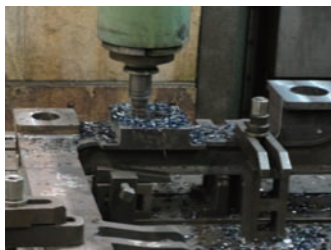
(a) \phi 50 mm玉米铣刀粗铣一系簧座板
