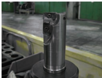
图5 \phi 20\text{mm} 钻铣刀
