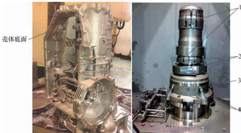
图1 变速箱壳体及其夹具示意图
