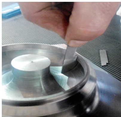
图8 样板1和样板2检测的实际效果
